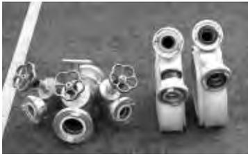
Die C-Druckschläuche sind beim Verteiler so vorzubereiten, dass die Kupplungen in Richtung Ziel zeigen und nicht am Boden aufliegen. In Laufrichtung rechts neben den C-Druckschläuchen ist ein Verteiler B-CBC aufgestellt.
