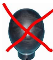
Prüfkopf zu stark aufgeblasen.
