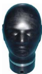
Ideale Kopfform für Maskenprüfungen
