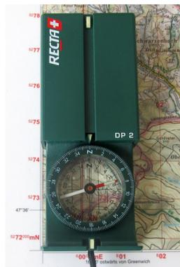
2. Die Karte mit der Bussole so lange drehen, bis sich die Spitze der Magnetnadel mit der Ablesemarke deckt. Die Karte ist nun eingonordet und alle Himmelsrichtungen in der Karte und im Gelände verlaufen gleich.
